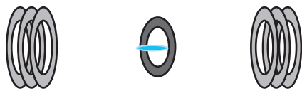
תרשים 5: המהוד האלקטרוסטטי עם אלקטרודות הטבעת קולטת האותות
