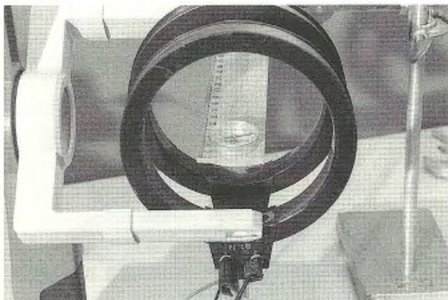
תרשים 2: הצבה נכונה של סלילי הלמהולץ בעזרת מצפן.
