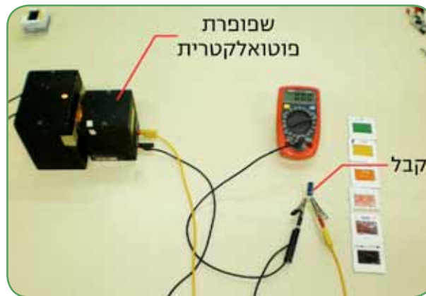
איור 3: טעינת הקבל על ידי מקור מתח פוטואלקטרי. לחוט השחור המחבר בין הקבל למד המתח אין תפקיד בטעינה, והוא נועד לשמש רק בשלב הבא, שלב הפריקה.
