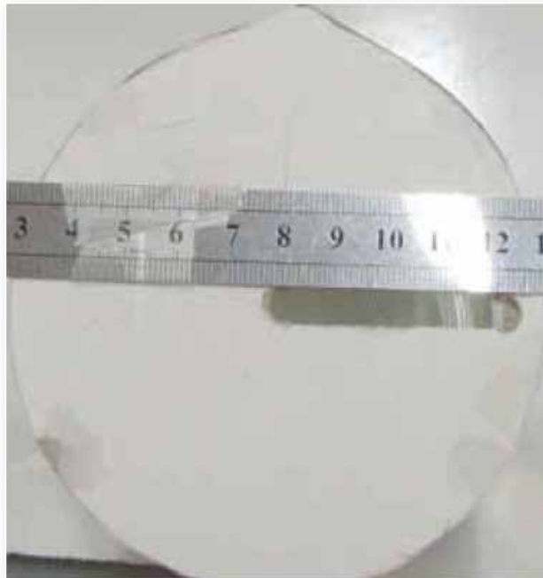
איור 1: המכסה של כלי הקיבול עם הפתח עבור המוט. שימו לב לסרגל המודבק לשפת הפתח.
