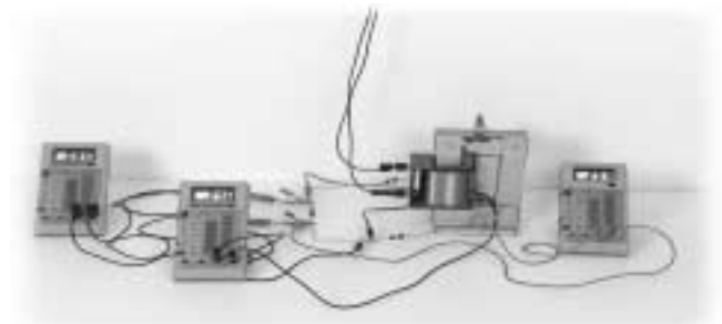
תרשים ג1: תצלום המערכת בה מחוברים שלושה וולטמטרים
